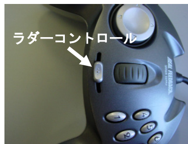
図 6 ラダーコントロール
